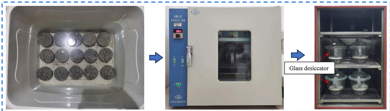
Fig. 5 Equilibrium moisture content test
