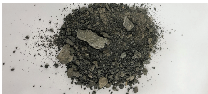
Fig. 8: Clínter modificado con cenizas de la incineración de RSU creado utilizando una adición del 1 al 2% de BA de la incineración de RSU a la alimentación del horno de cemento.
