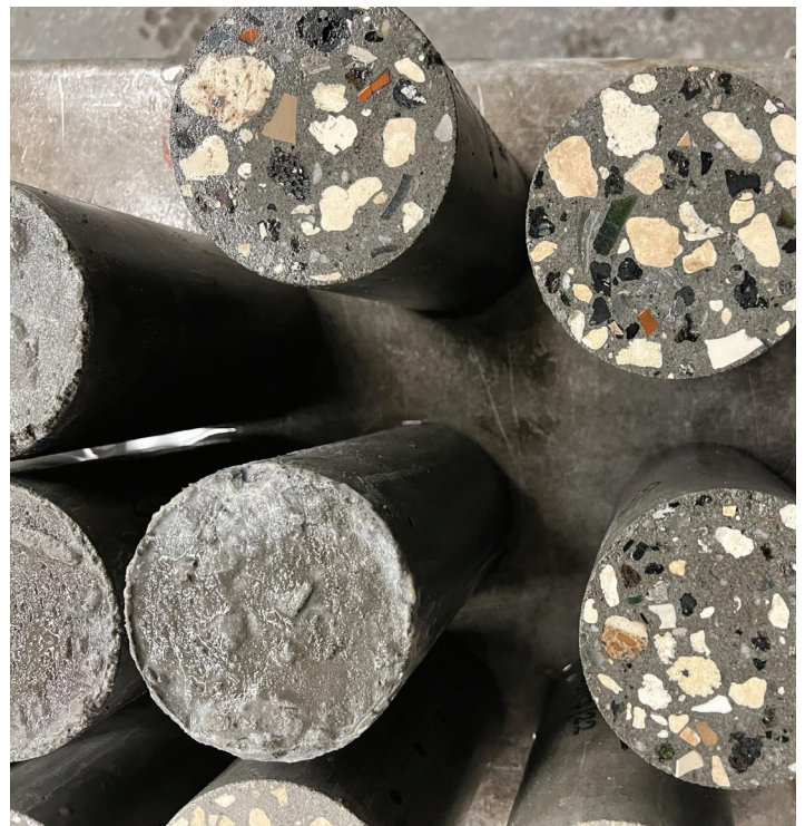
Fig. 2. Cilindros de ensaye con BA de la incineración de RSU como agregado
