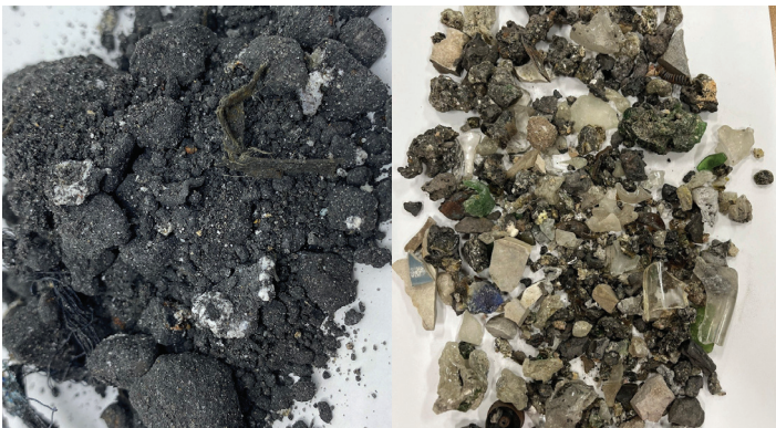
Fig. 1. Cenizas de fondo (BA) frescas (izq.) y lavadas (der.) de la incineración de RSU
