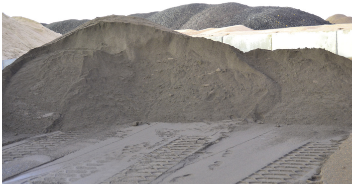
Agregado ligero prehumedecido listo para mezclado (foto de cortesía del Instituto de Agregados Livianos de Esquistos, Arcilla y Pizarra Expandida).
