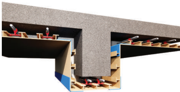
Fig. 6: Las vigas de concreto y las losas pueden ser reparadas en unas horas con paneles T.
