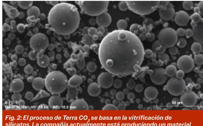
*Fig. 2: El proceso de Terra CO<sub>2</sub> se basa en la vitrificación de silicatos. La compañía actualmente está produciendo un material cementante suplementario puzolánico vítreo y microesférico, y está desarrollando un aglutinante no hidráulico.*
