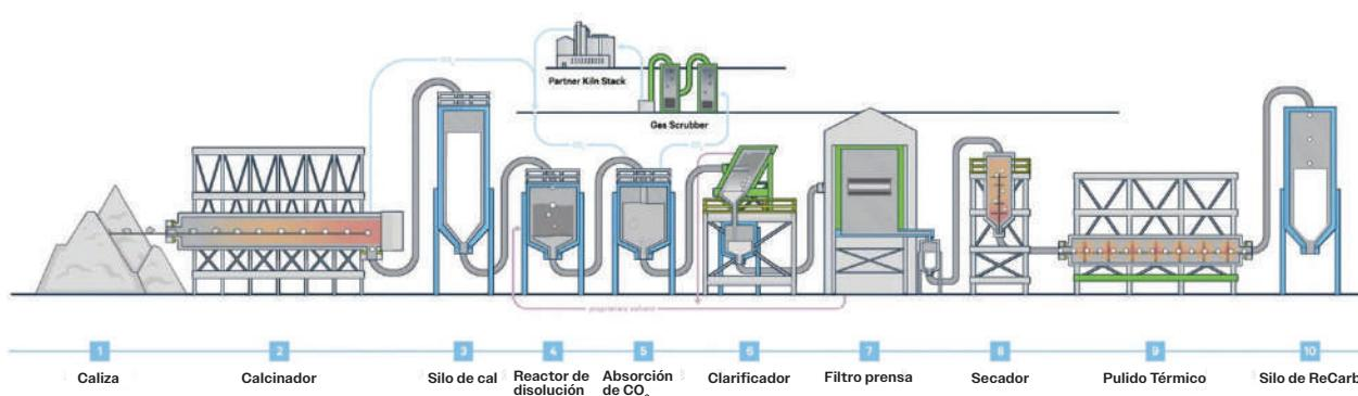
Fig. 1: El proceso de Fortera produce carbonato de calcio reactivo disolviendo cal en un solvente de marca registrada, bombeando  $\text{CO}_2$  a través de la solución y procesando el precipitado resultante.
