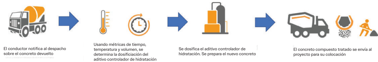
Fig. 1: Pasos para tratar y reutilizar el concreto plástico devuelto
