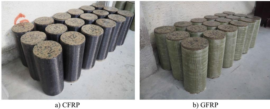
**Fig. 2** FRP wrapped specimens
