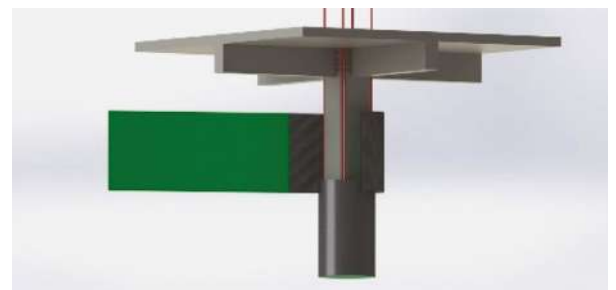
Fig. 3: Instalación de laminados alrededor de la columna para crear una carcasa
