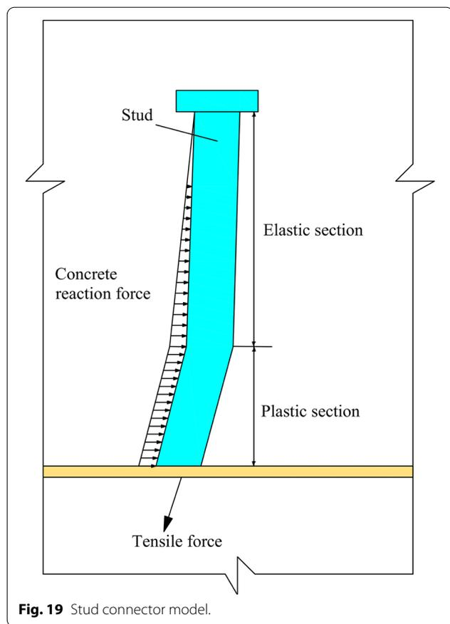
**Fig. 19** Stud connector model.
