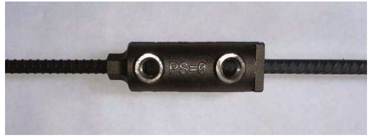
Fig.3 El Sistema de Empalme Mecánico de Barras de Refuerzo PS=Ø puede asegurar continuidad dúctil y una tira de vertido sin espacios.
