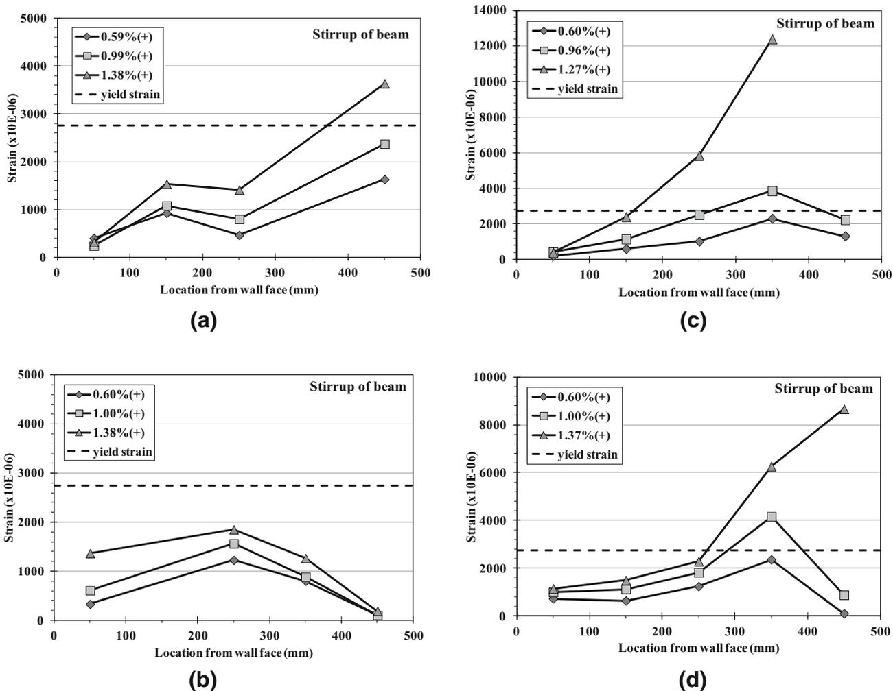
Fig. 16 Strain levels of stirrups. a B-1-H, b B-1-HA, c B-2, d B-2-H.
