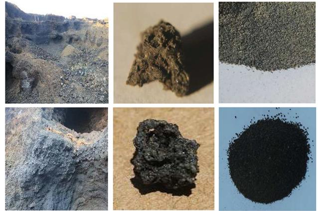
**(a)** Pozzolan quarry. **(b)** gravel pozzolan. **(c)** fines pozzolan.
