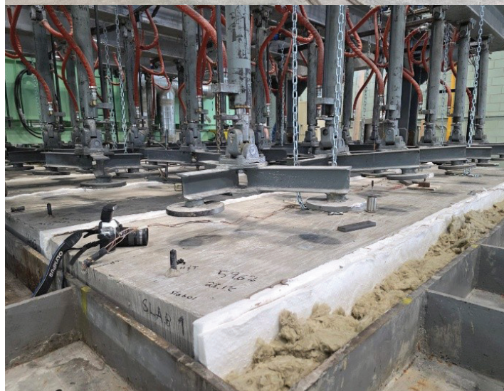
Fig. 3: Investigación en curso dirigida por Mark Green, de Queen's University, y Hamzeh Hajjloo, de Carleton University, sobre concreto reforzado con GFRP bajo condiciones de incendio (Fotos cortesía de MST Rebar Inc.)
