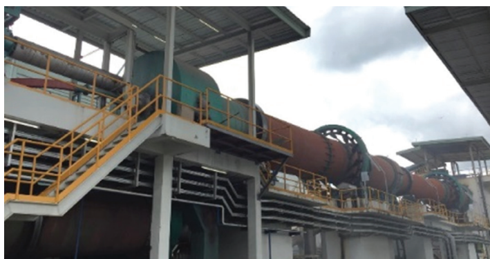
Fig. 2: Horno rotatorio utilizado para calcinar arcilla
