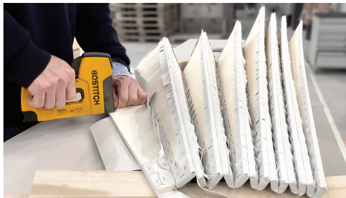
Se aplican capas textiles en uno de los lados de las tiras para unir las entre sí.
