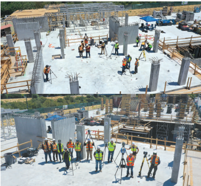
Fig. 1: Vista parcial del área de prueba, participantes y sus instrumentos de Escaneo Láser Terrestre (TLS)
