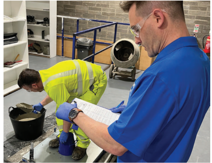
Fig. 2: Examinador de certificaciones supervisando una prueba de ensayo de flujo de la EN.
