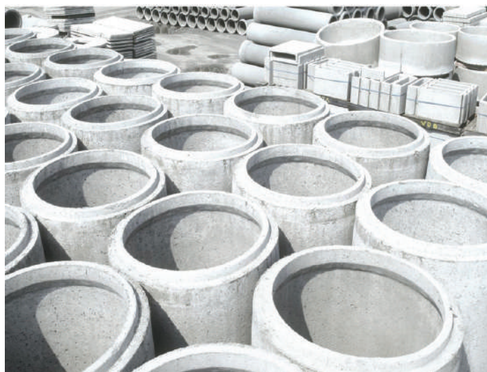
Fig. 2: Desde 1995 en Francia, SIMAT ha fabricado tubos prefabricados con fibras de acero.
