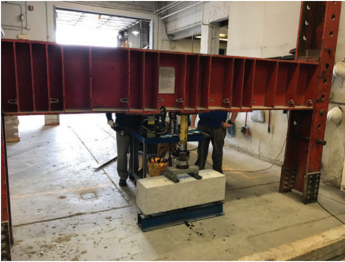
Figura 1. Configuración de ensayos de flexión ASTM C78/C78 M.
