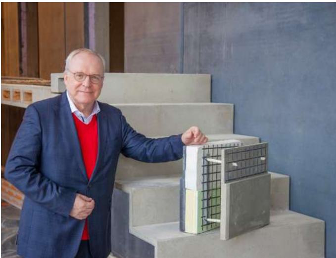
Figura 2: La estructura de caja de dos pisos dentro de The Cube está hecha de paredes dobles aisladas de hormigón prefabricado; una sección mostrada a la derecha por Manfred Curbach (foto cortesía de Stefan Groeschel, IMB, TU Dresden)
