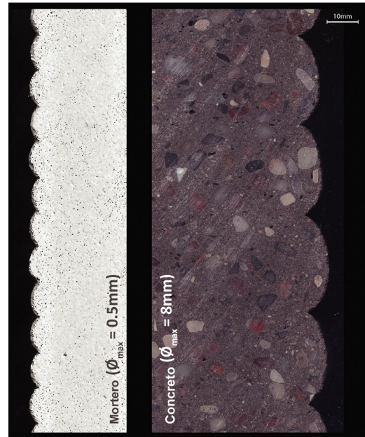
Figura.3. Detalle de las muestras de 3DCP producidas con mortero y con concreto
