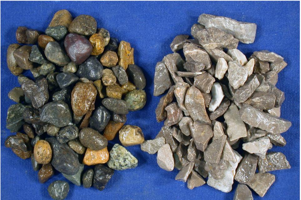
Fig. 0.2—Agregados gruesos (foto cortesía de CTLGroup)
