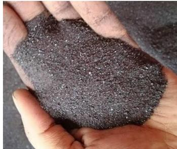
Fig 3.3 Copper slag
