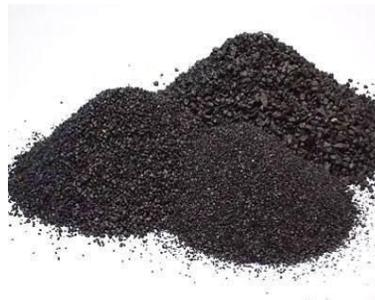
Fig 3.2 Waste steel slag
