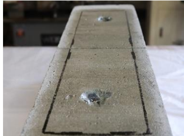
Epoxy primer coat
