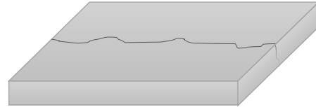
Top-Bottom Longitudinal crack
